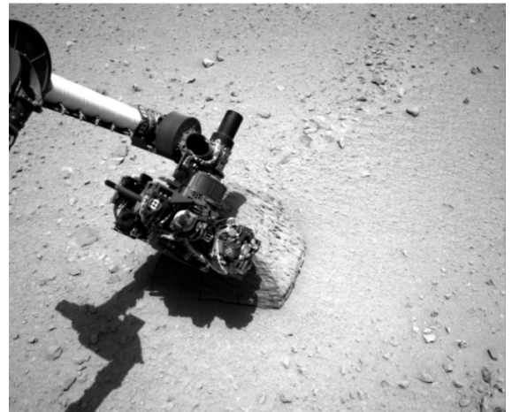
O APXS em uso, analisando uma rocha marciana
