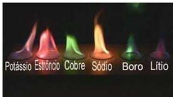
**Figura 2** – O teste de chama proporciona uma prova empírica de que Bohr estava certo ao afirmar que cada elemento, ao ser energizado por uma chama ou laser, emite um espectro correspondente à sua natureza
