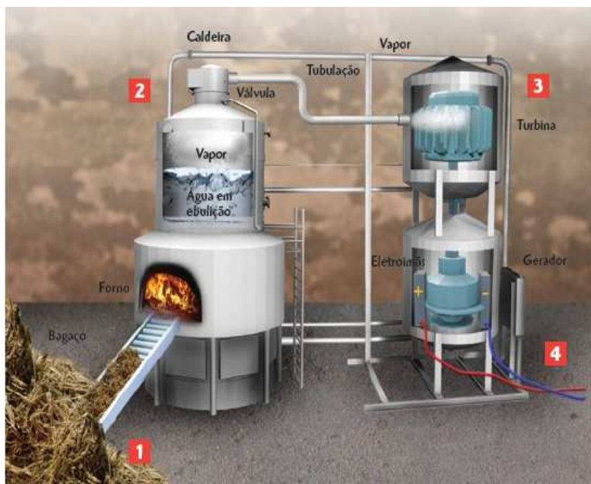
Figura 2. Esquema de uma usina termelétrica para a produção de energia elétrica a partir de biomassa 10 .
