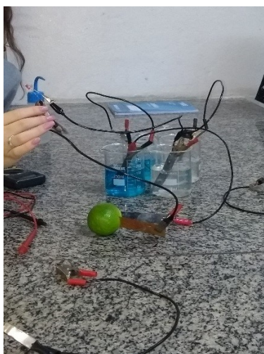
Figura 1: associação entre uma pilha de limão e uma pilha de Daniell
