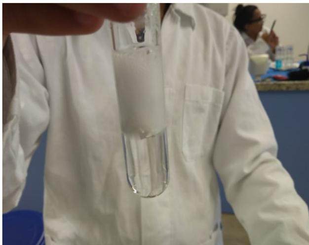
**Figura 3.** Reação num tubo de ensaio entre magnésio sólido e ácido clorídrico 10%. É possível observar a formação de um gás, evidência da reação.
