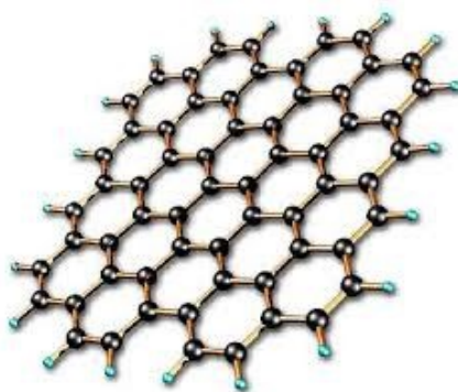
Figura 2 - Representação da estrutura hexagonal plana do grafeno
