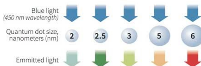
Figura 1 – Os pontos quânticos são capazes de converter um espectro de luz em cores diferentes. Esta cor emitida depende de seu tamanho. / Fonte: www.nanowerk.com/what_are_quantum_dots.php
