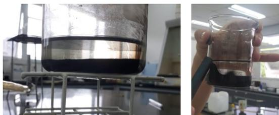
**Figura 8:** houve a sedimentação após a mistura ser deixada por um período.
