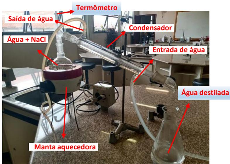
Figura 1 – Destilação de água salinizada
