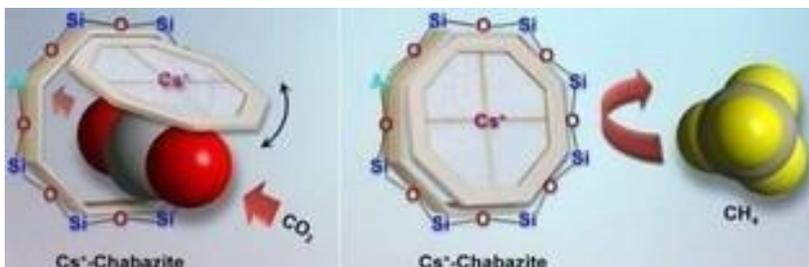
(Figura 2) “Alçapão Molecular”. Ao passar pela nanopeneira, a molécula de  $\text{CO}_2$  é aprisionada em seu interior.
