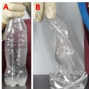
Figura 8 [11] – Sistema antes e depois da captura do CO 2 .
