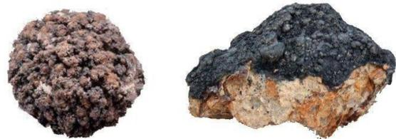
**Figura 1.** Na esquerda, um nódulo polimetálico. Na direita, uma crosta polimetálica.
